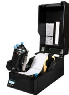
Durch den Frontzugriff auf alle Standard-Funktionen ist der Drucker für das leichte Laden von Medien und die einfache Wartung ausgelegt.
